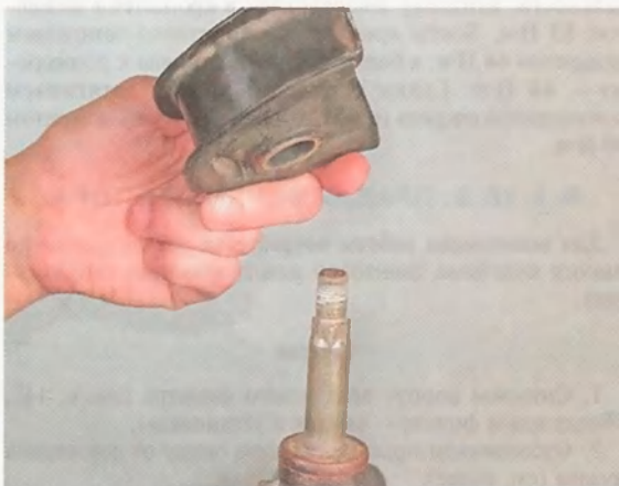
7. Снимаем опору со шпильки кронштейна.
