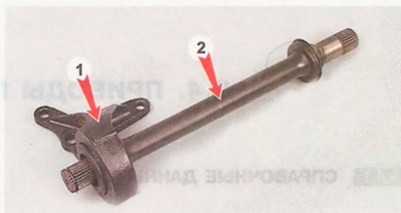
Промежуточный вал: 1 — опора; 2 — вал
