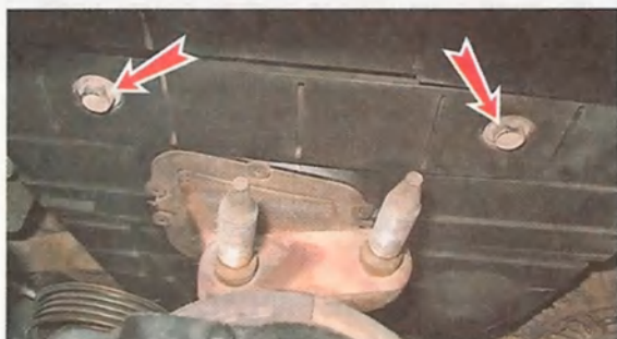
12. Вынимаем болты из отверстий.
