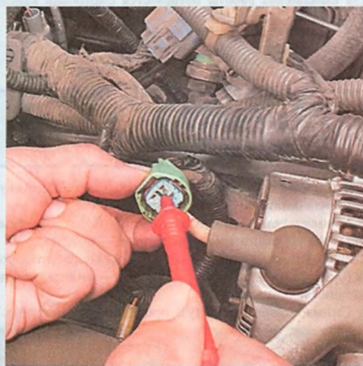
Выводы генератора: 1 — разъём для подсоединения колодки жгута проводов; 2 — вывод В
