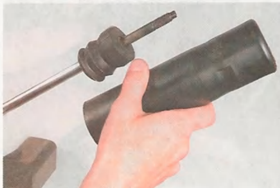
8. Снимаем защитный кожух.
