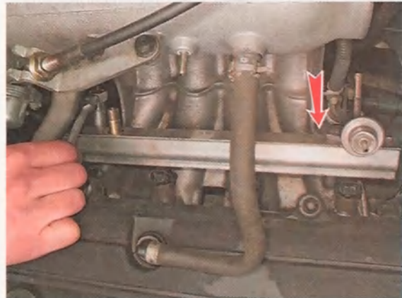
10. Снимаем топливную рампку в сборе с форсунками.
