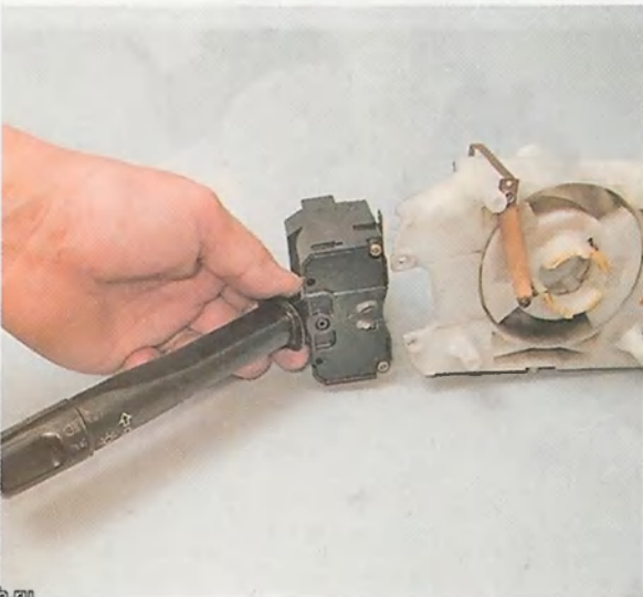
Расположение выводов в выключателе наружного освещения (13.9.1)
