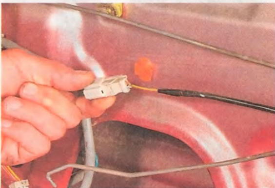
6. Снимаем колодку жгута проводов с держателя.
