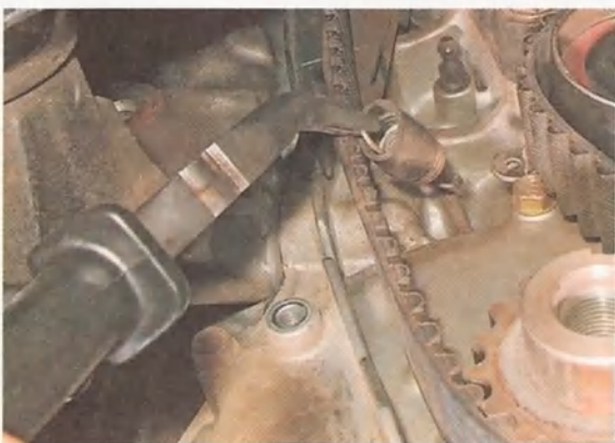
19. Снимаем пружину натяжного ролика.
