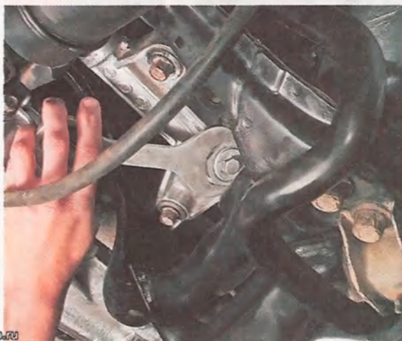
3. Ключом на 40 мм ослабляем затяжку контргайки.
