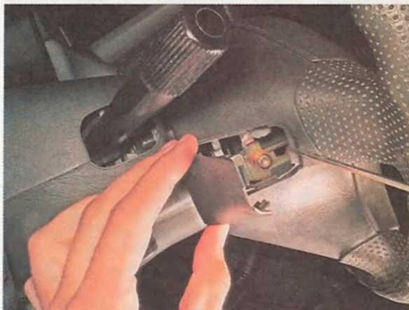
8. Поддеваем отвёрткой и открываем заглушку с правой стороны рулевого колеса. Отвёрткой отжимаем фиксатор и снимаем заглушку.
