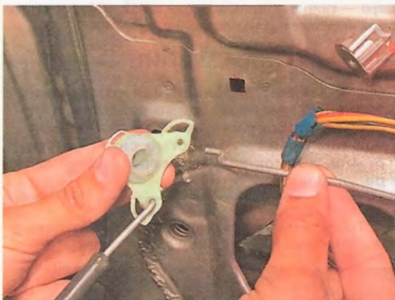
5. Разъединяем колодку жгута проводов замка.
