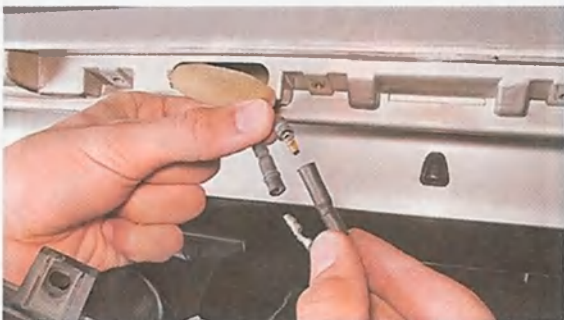
5. Разъединяем колодку и снимаем фонарь дополнительного сигнала торможения с автомобиля.
