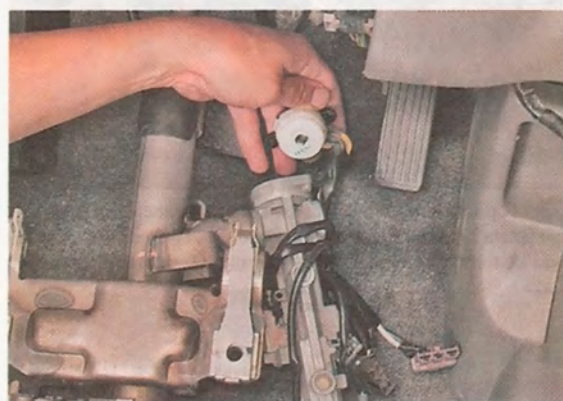
6. Устанавливаем новую контактную группу в обратной последовательности.
