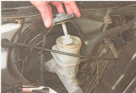
5. Извлекаем из цилиндра стакан с сетчатым фильтром.
