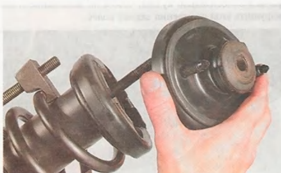
6. Снимаем резиновую прокладку пружины.
