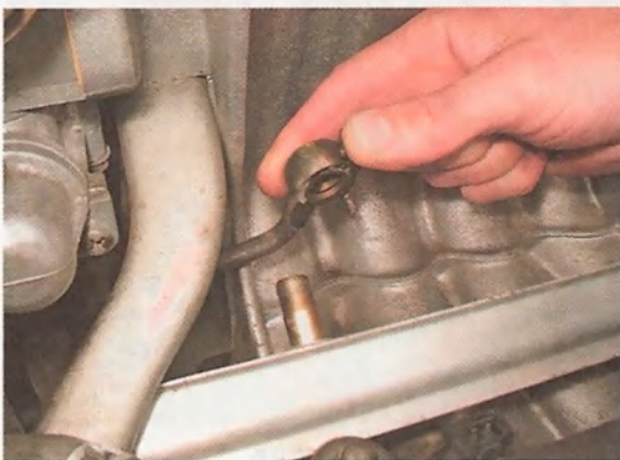
8. Снимаем со штуцера топливной рампы наконечник шланга топливопровода...
