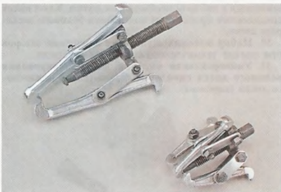
13. Универсальный съёмник с узкими захватами для снятия муфт, шестерён, колец подшипников. Конструкция съёмника позволяет комбинировать, устанавливая два или три захвата.
