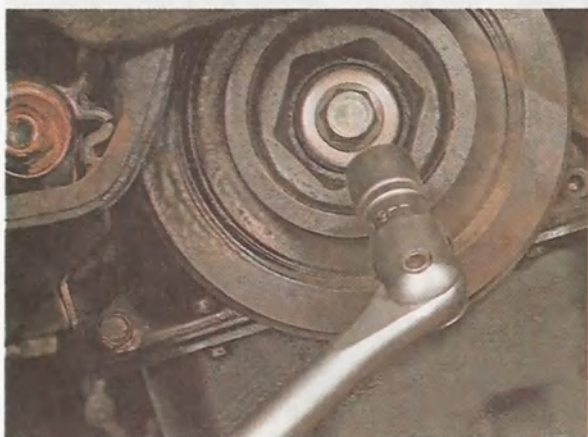
...торцовым ключом на 19 мм отворачиваем болт крепления шкива коленчатого вала.
