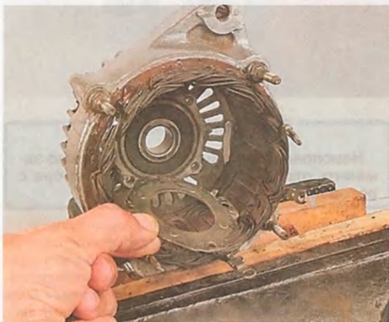
7. Снимаем стопорную пластину.
