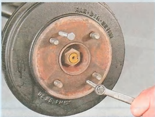
7. Снимаем тормозной барабан с автомобиля.
