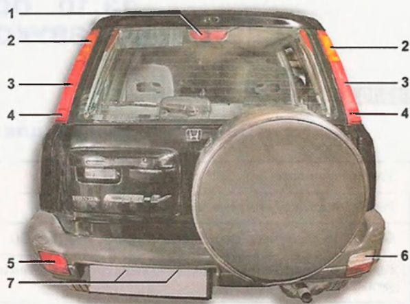
Задние фонари (европейский вариант исполнения): 1 — дополнительный фонарь сигнала торможения; 2 — секции задних указателей поворота; 3 — секция сигнала торможения и габаритного света; 4 — светоотражатели; 5 — фонарь заднего противотуманного света; 6 — фонарь света заднего хода; 7 — фонари освещения номерного знака
