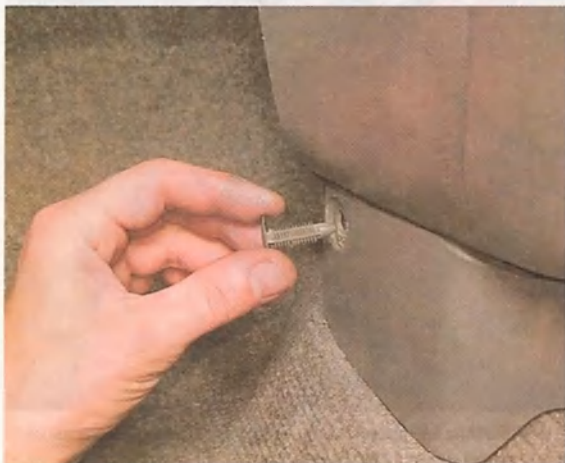
...извлекаем держатель накладки.
