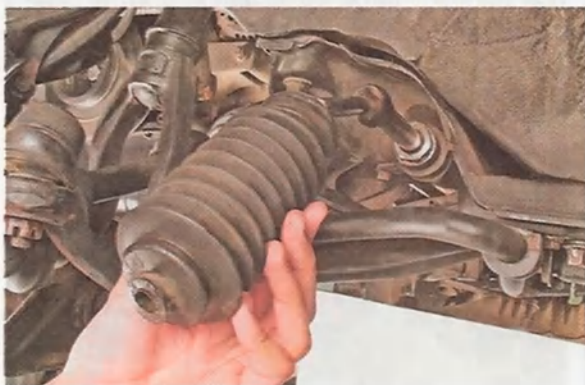
4. Свинчиваем с рулевой тяги контргайку наконечника.
