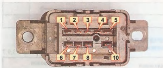
Расположение выводов в выключателе аварийной сигнализации
