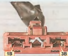
Расположение выводов в колодке В жгута проводов выключателя зажигания
