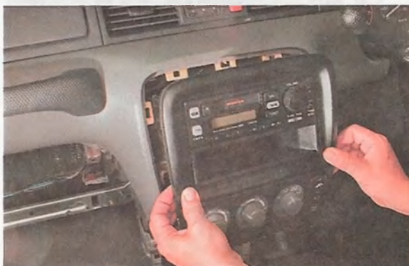
15. Отсоединяем штекер антенны от автомагнитолы.
