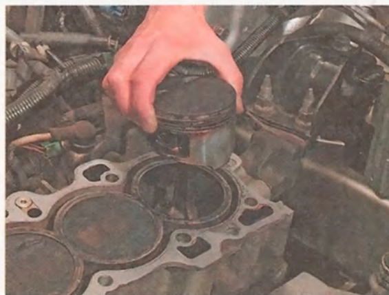
8. Извлекаем поршень в сборе с шатуном из цилиндра.
