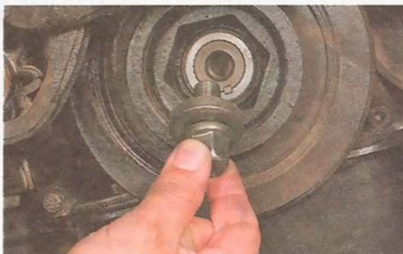
8. Покачивая из стороны в сторону, снимаем шкив с коленчатого вала.
