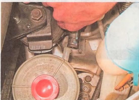
4. Отсоединяем шланг от штуцера бачка.
