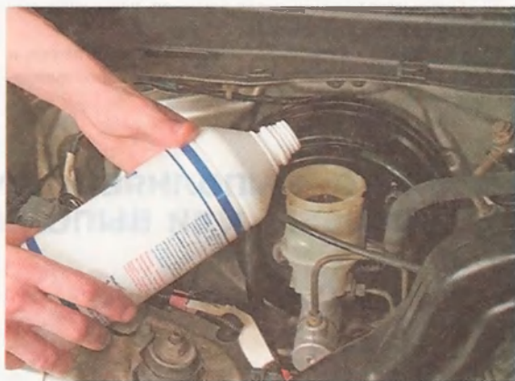
7. Заливаем в бачок новую жидкость (DOT-3 или DOT-4).
