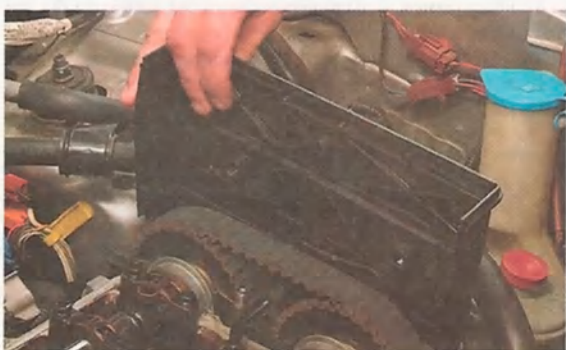
14. Торцовым ключом на 10 мм отворачиваем четыре болта крепления нижней крышки ремня привода ГРМ.
