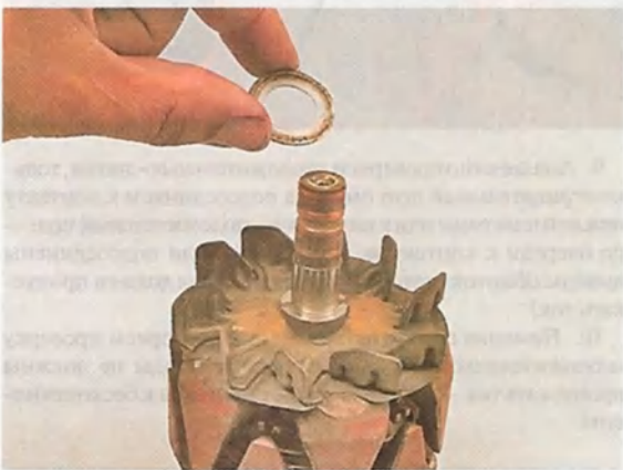
4. Снимаем дистанционную шайбу.
