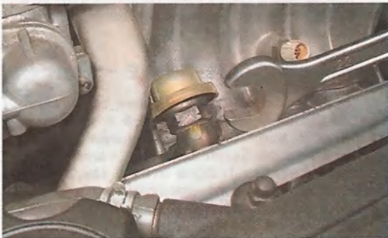
7. Снимаем демпфер и уплотнительное кольцо.
