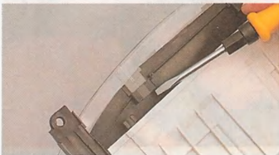
3. Снимаем стекло со щитка.
