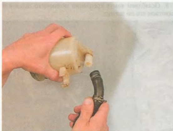
10. Устанавливаем бачок системы гидроусилителя рулевого управления в обратной последовательности.
