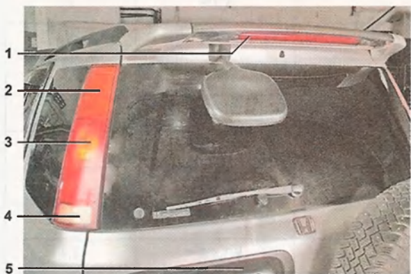
Задние фонари (азиатский вариант исполнения): 1 — дополнительный фонарь сигнала торможения; 2 — секция заднего указателя поворота; 3 — секция сигнала торможения и габаритного света; 4 — секция света заднего хода; 5 — фонарь освещения номерного знака
