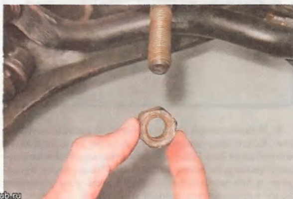
4. Свинчиваем с рулевой тяги контргайку наконечника.
