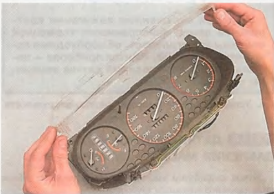
3. Снимаем стекло со щитка.
