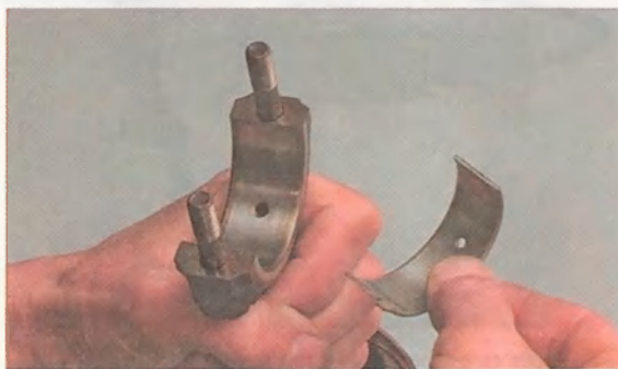
1. Извлекаем вкладыши из шатуна и его крышки.
