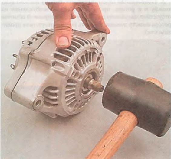
20. Молотком с резиновым бойком лёгкими ударами по торцу вала ротора выбиваем вал из переднего подшипника (достаточно стронуть вал с места).
