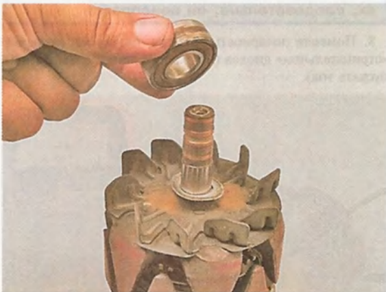
4. Снимаем дистанционную шайбу.
