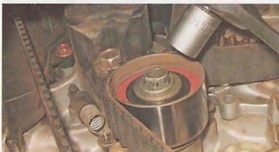
19. Снимаем пружину натяжного ролика.
