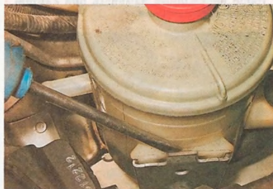
7. Выводим шланг из кронштейна на корпусе бачка.
