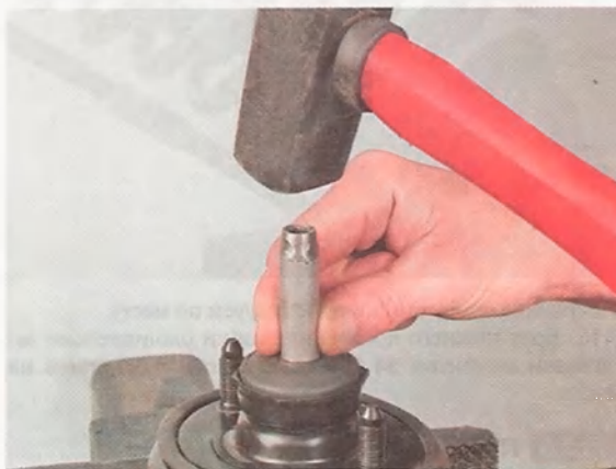
11. Поддеваем отвёрткой и извлекаем верхнюю резиновую подушку.
