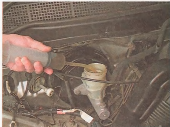
7. Заливаем в бачок новую жидкость (DOT-3 или DOT-4).
