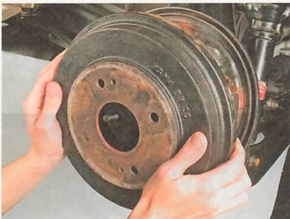
7. Снимаем тормозной барабан с автомобиля.
