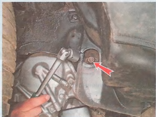
2. Торцовым ключом на 14 мм отворачиваем два болта крепления опоры к лонжерону кузова.
