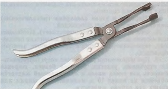
14. Приспособление для замены маслосъёмных колпачков.
