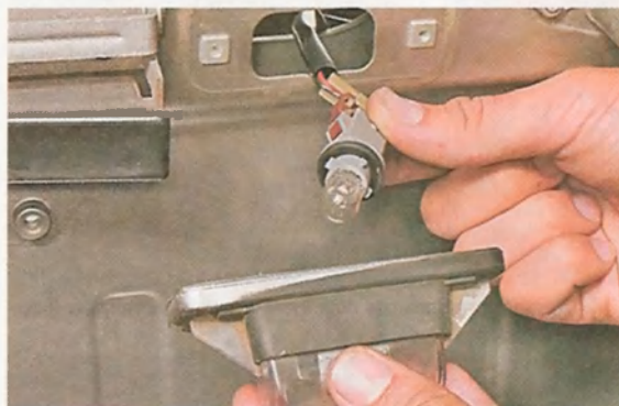
6. Извлекаем лампу из патрона и устанавливаем новую.
