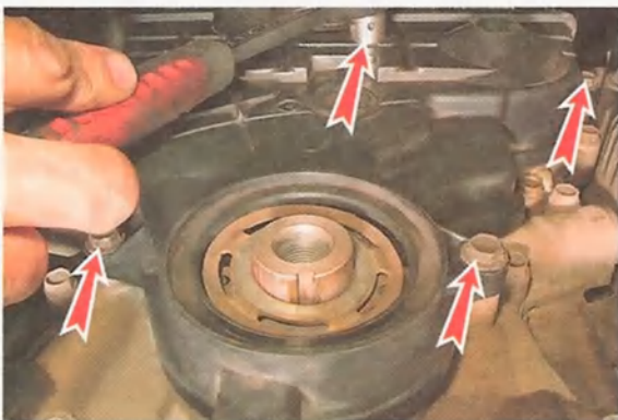
14. Торцовым ключом на 10 мм отворачиваем четыре болта крепления нижней крышки ремня привода ГРМ.
