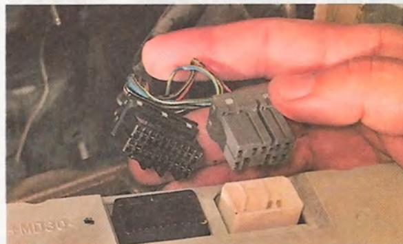
18. Снимаем блок управления в сборе облицовкой и автомагнитолой.
