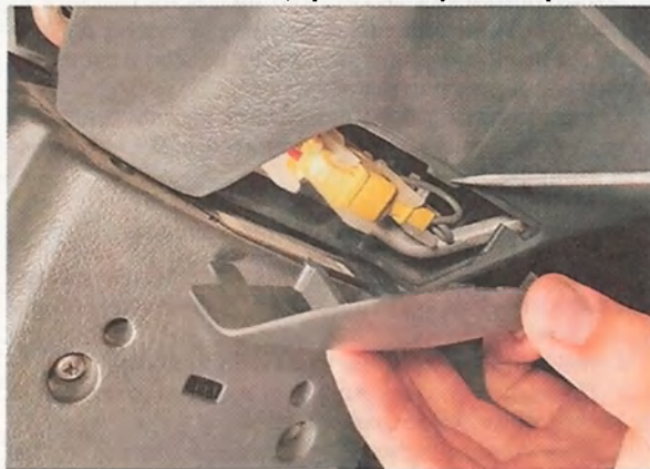
5. Извлекаем колодку жгута проводов подушки безопасности из держателя.
