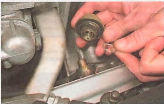
8. Снимаем со штуцера топливной рампы наконечник шланга топливопровода...
