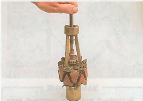
3. Снимаем подшипник с вала.
