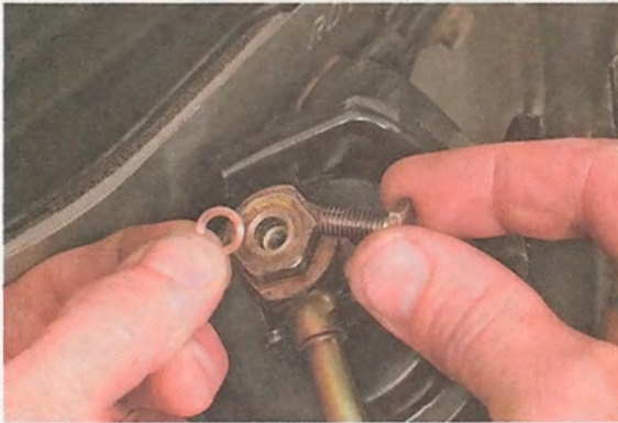
3. На место пробки заворачиваем штуцер манометра.
