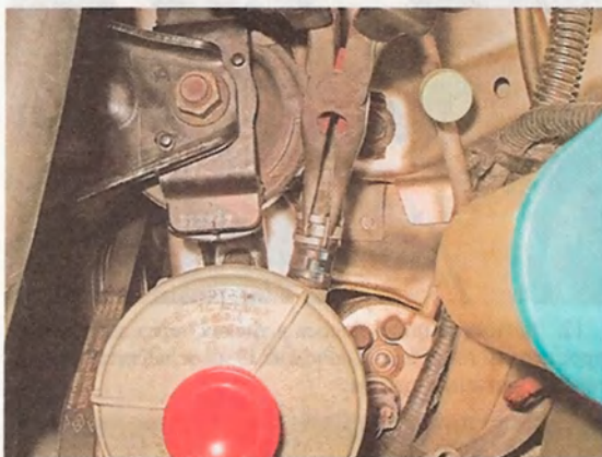
4. Отсоединяем шланг от штуцера бачка.
