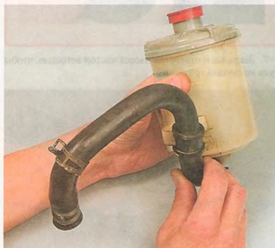
8. Ослабляем хомут крепления шланга к штуцеру бачка и сдвигаем его по шлангу.
