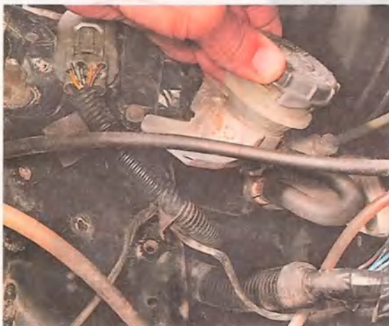
3. Приподнимаем бачок вместе с кронштейном.
