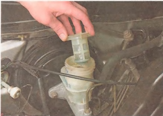
5. Извлекаем из цилиндра стакан с сетчатым фильтром.
