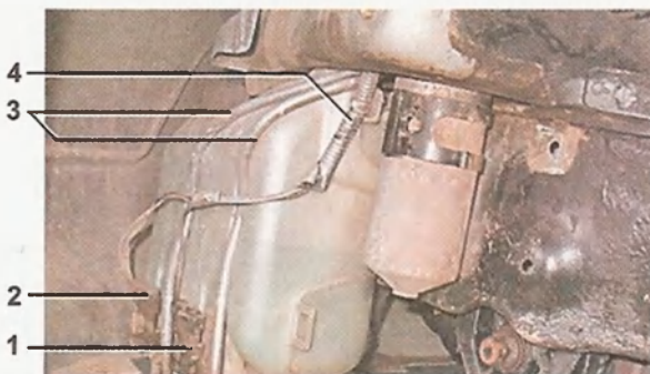
Бачок стеклоомывателей: 1 — насос омывателя заднего стекла; 2 — насос омывателя ветрового стекла; 3 — гибкие трубки подвода жидкости к форсункам; 4 — жгут проводов цепи питания электронасосов
