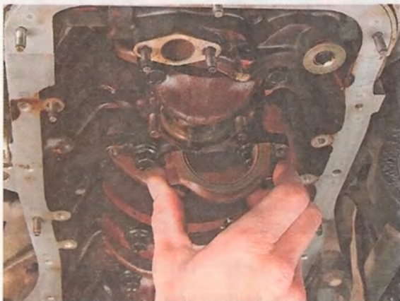
7. Деревянным брусом или ручкой молотка выталкиваем поршень вверх.
