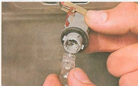
6. Извлекаем лампу из патрона и устанавливаем новую.
