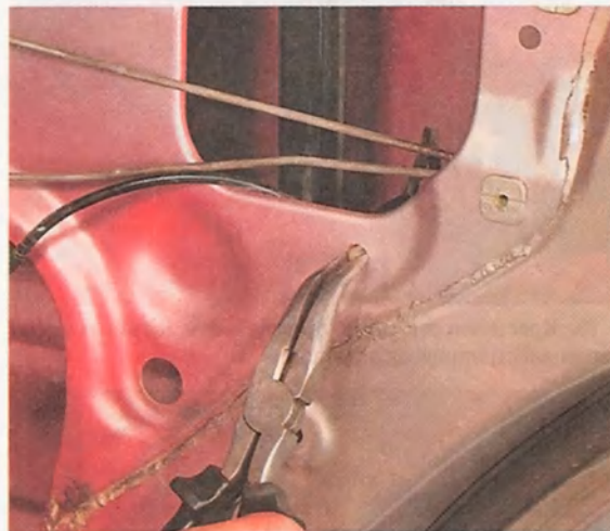
8. Извлекаем замок с тягами из двери через технологическое отверстие.
