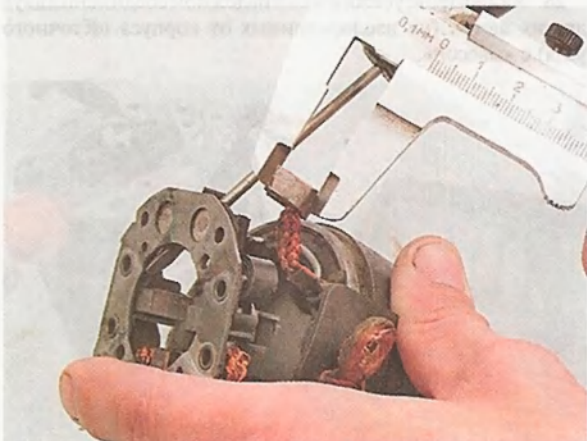
31. Аналогично измеряем высоту трёх других щеток.
