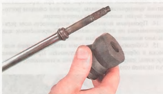
10. Закрепляем опору в тисках и выпрессовываем распорную втулку.
