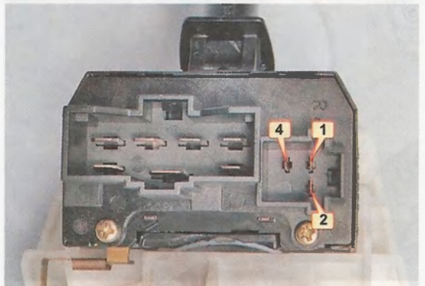
Расположение выводов в переключателе указателей поворота (13.9.2)
