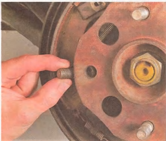
4. Извлекаем шпильку из ступицы.
