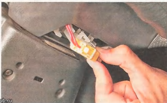
5. Извлекаем колодку жгута проводов подушки безопасности из держателя.
