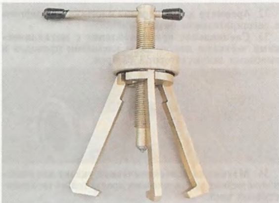
14. Приспособление для замены маслосъёмных колпачков.
