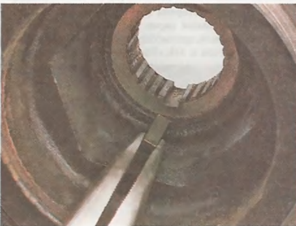
9. Чтобы не потерять, извлекаем из паза шпонку.
