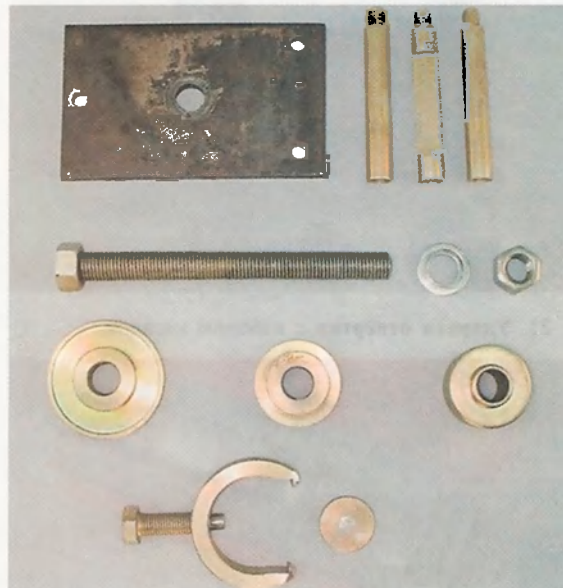
16. Съёмник чашечный универсальный для извлечения и запрессовки подшипников ступиц и резино-металлических шарниров (сайлент-блоков) рычагов.
