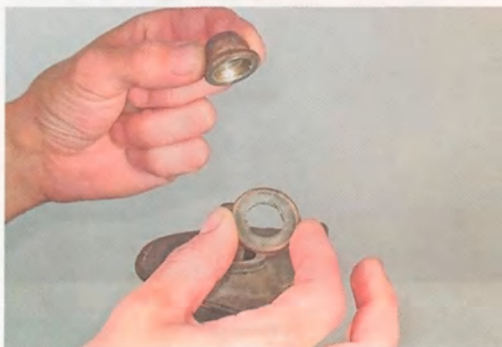
7. Снимаем опору со шпильки кронштейна.
