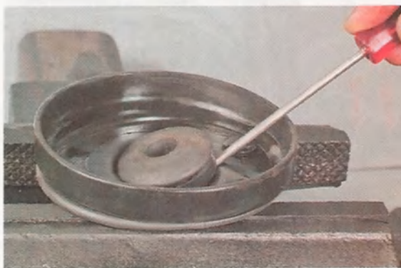
12. Аналогично снимаем нижнюю подушку.
