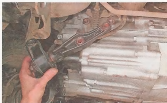
5. Зажав кронштейн в тисках, отворачиваем гайку крепления опоры к кронштейну.
