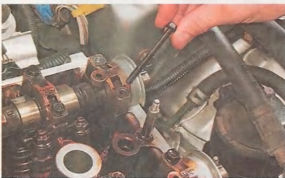
11. Поддев шлицевой отверткой...
